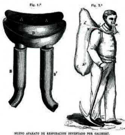
F 5 Aparato respirador Galibert.
