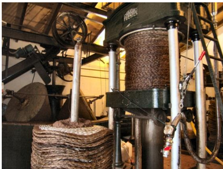
Interior de molino aceitero con prensa hidráulica.
