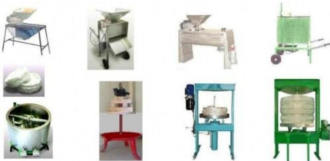
Diferentes tipos de almazaras de capachos.
